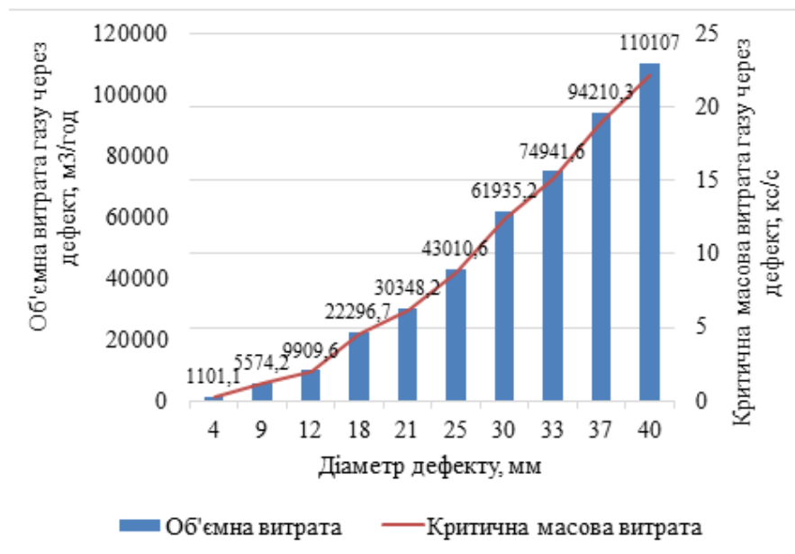
Рис. 6. Залежність витрат газу через наскрізний дефект типу "свищ" від його діаметру
