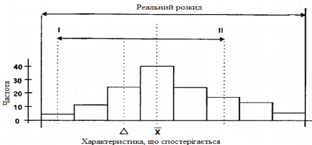
Рис. 4 Гістограма розподілу частоти: I - верхня межа поля допуску; II - нижня межа поля допуску; Δ - середина поля допуску; \bar{x} - середнє арифметичне значення
