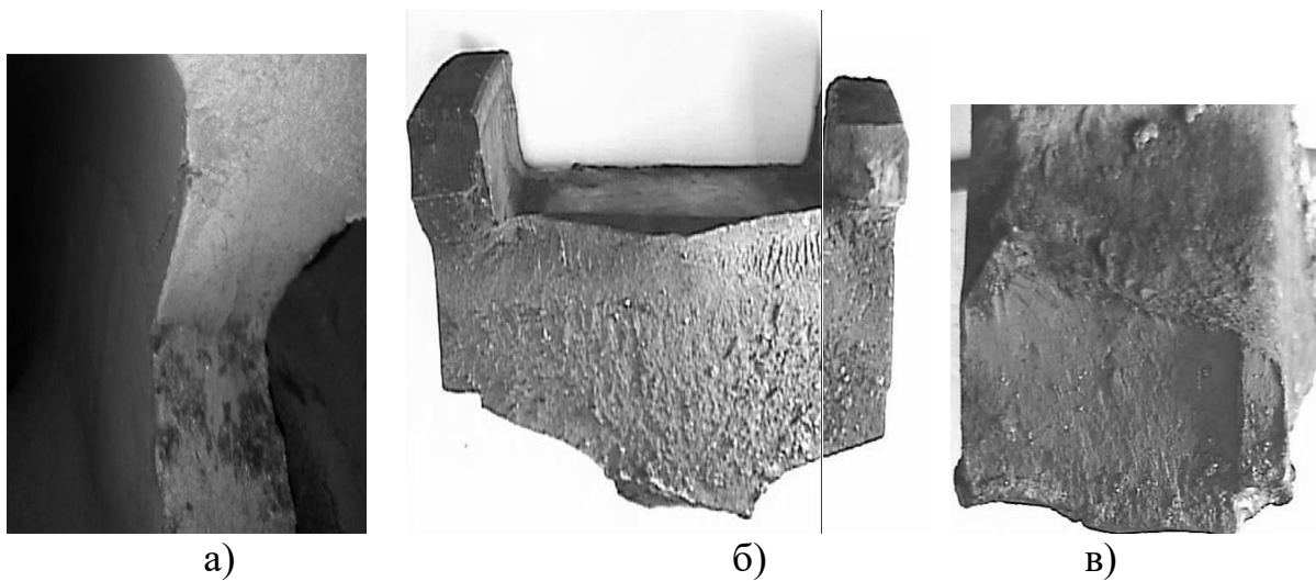
Рис. 2 Макроструктура фрагментів кранового колеса
