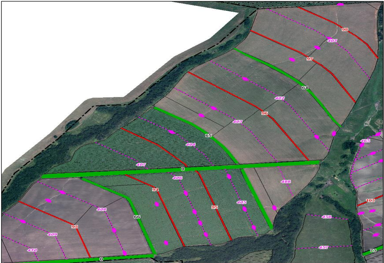
Рис. 3. Схема можливого розміщення мулофільтрів на довгому схилі розсіюючого типу північно-східної експозиції з базисом ерозії 100 м південно-західної частини території колишнього ДГ «Ударник»
