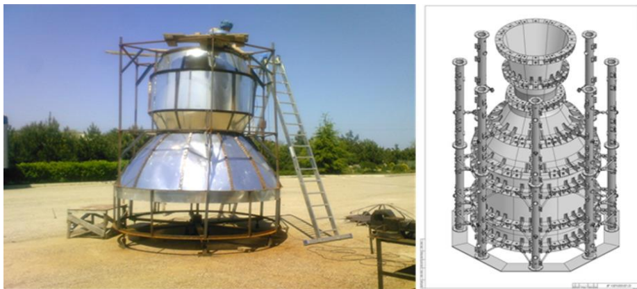
Рис. 1. Зовнішній вигляд дослідного зразка та конструкція вертикальної енергоустановки ІПЕ «СМЕРЧ»
