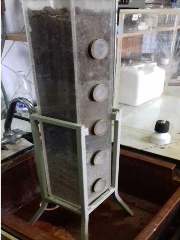
Рис. 2. Експериментальна установка процесу фільтрації поверхневих вод
