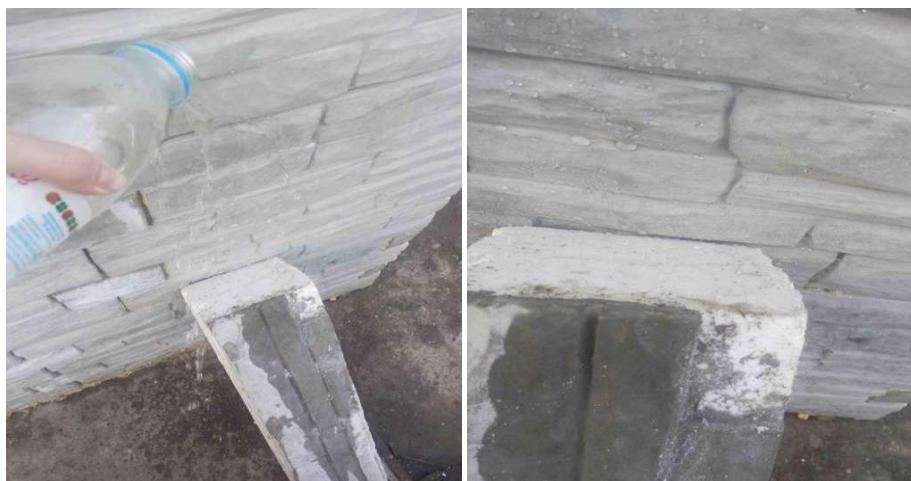
**Рис. 6. Порівняння поверхні фасадної плити, обробленої водо-**
