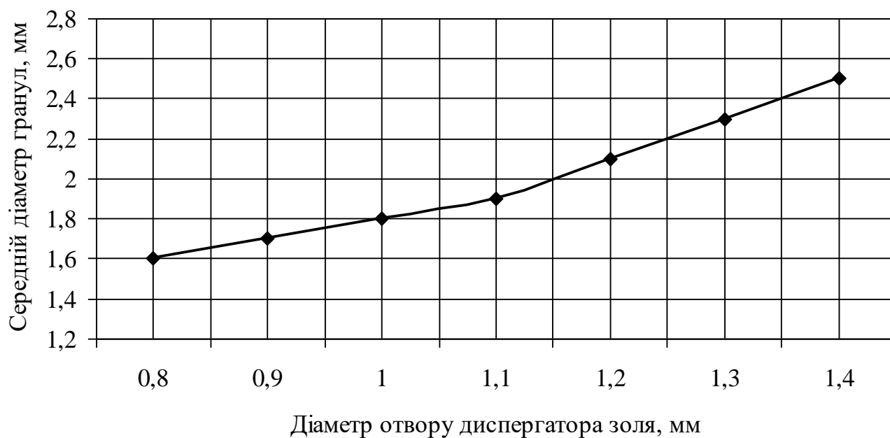
Рис. 2. Залежність діаметра гранул від діаметра отвору диспергатора
