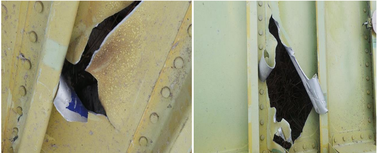
Рис. 3-4. Пробоїни в обшивці крила літака з пошкодженням полук силових стрингерів.
