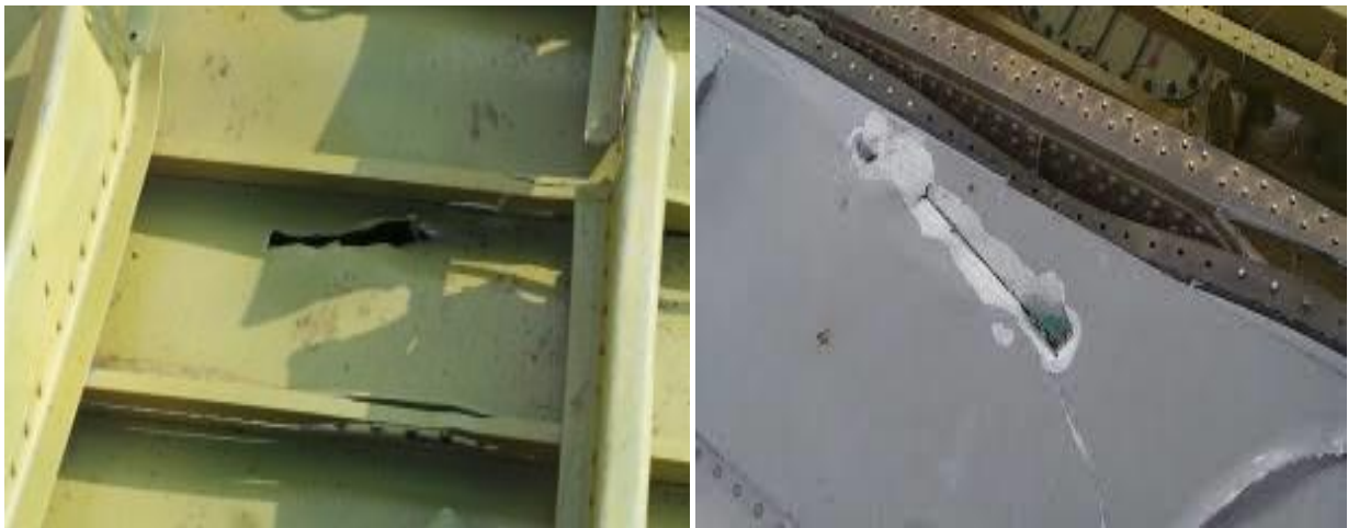
Рис. 5-6. Пробоїни в обшивці крила літака без пошкодження силового набору крила
