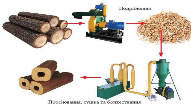
Рисунок 1.1. Технологія виробництва паливних брикетів
