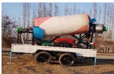
рис.1. Передвижное сушильное устройство для сушки шала
