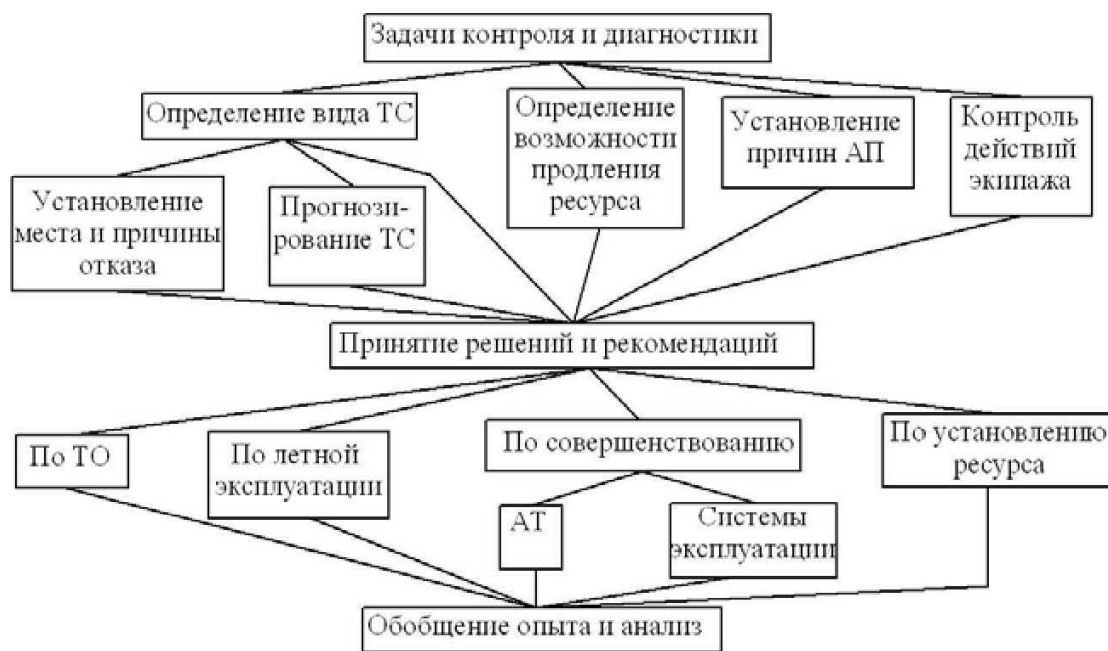
Рис. 3. Эксплуатационные задачи технической диагностики ЛА
