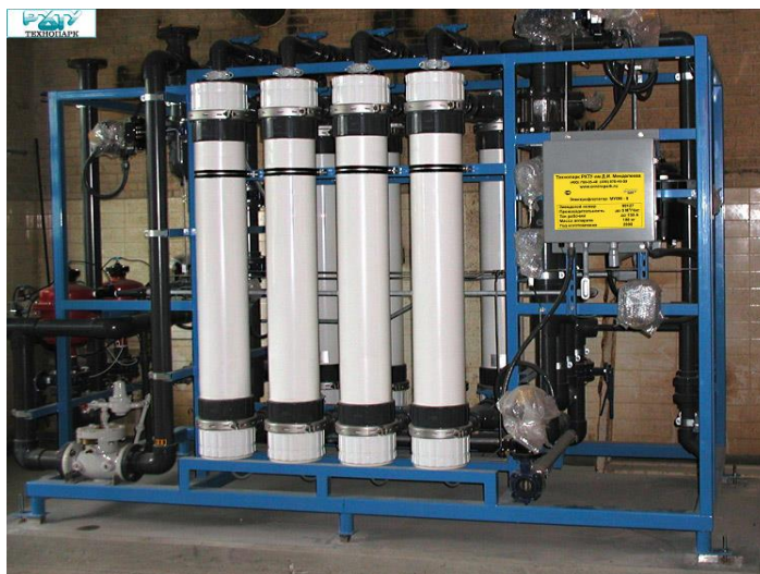
Рис. 1. Установка ультраfiltrации на основе полуволоконных мембран
