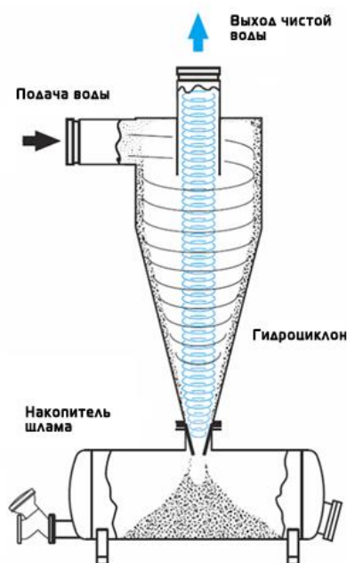
Рис. 5. Напорный гидроциклон
