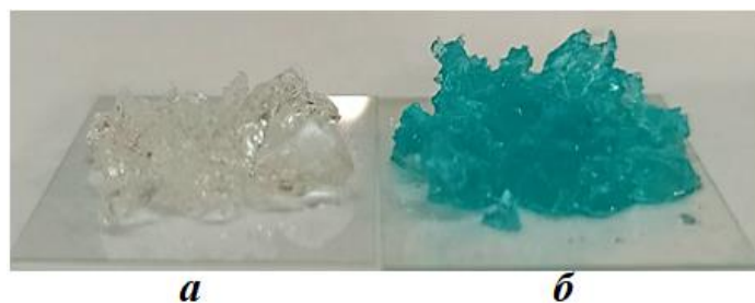
Рис. 1. Співполімер акриламід з акриловою кислотою набухлий до (а) та після сорбції міді(II) (б)
