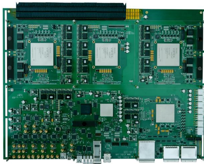
Рис. 3. Типова плата для емуляції проектів на FPGA
