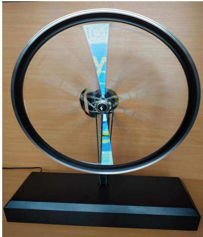
Рис. 3. Стенд для формування динамічно розгорнутого кольорового зображення в площині
