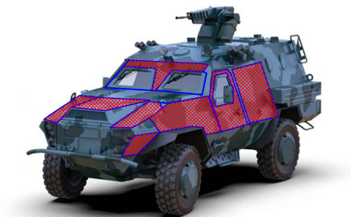
Рис. 1. Розташування багатошарового демпфуючого покриття на корпусі бронев автомобіля «Дозор-Б»
