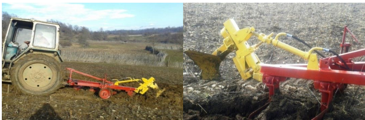
Рис. 4. Экспериментальный плуг в рабочем положении.
