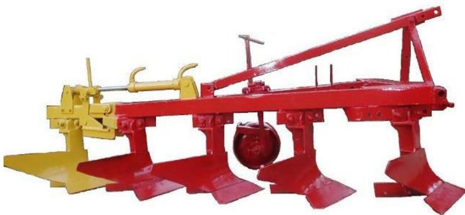
Рис. 3. Экспериментальный плуг с изменяемой шириной захвата.
