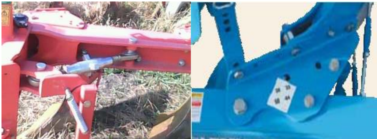
Рис. 1. Винтовые механизмы для регулировки ширины захвата плуга.
