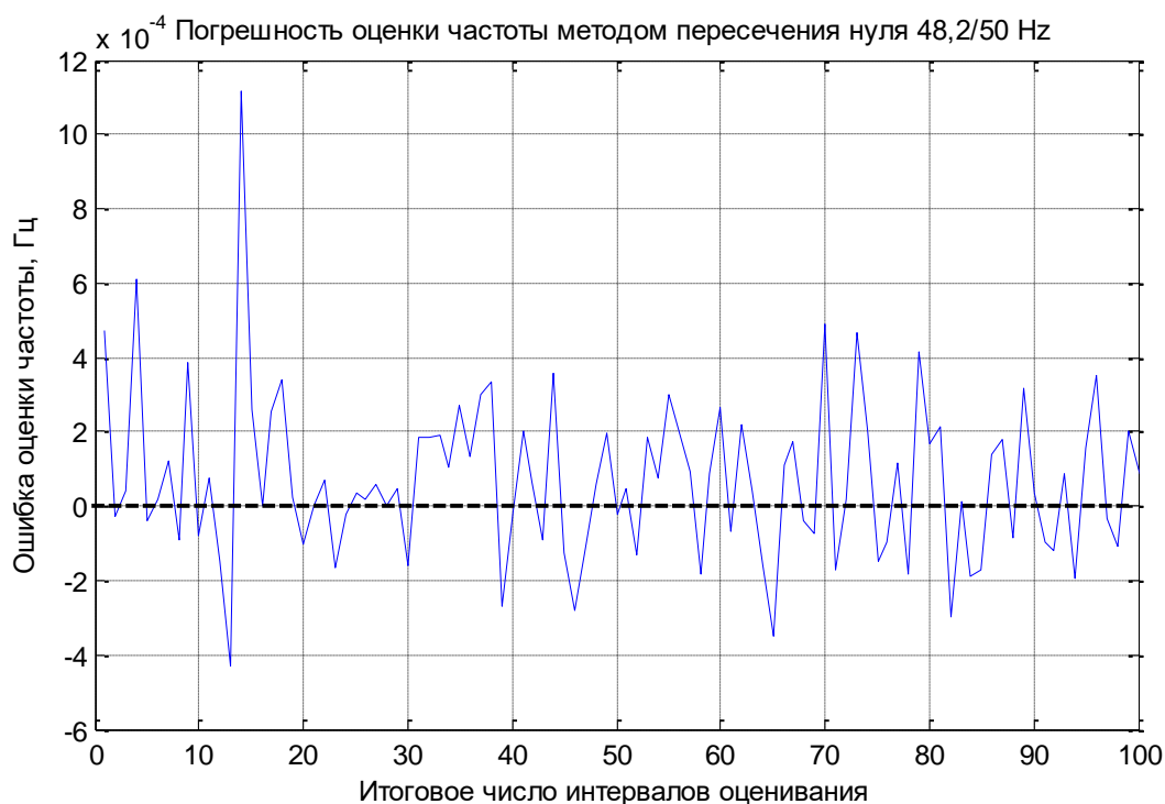
Рис. 1 Ошибка оценивания частоты по переходу через нулевой уровень согласно IEC 61000-4-30 [1]
