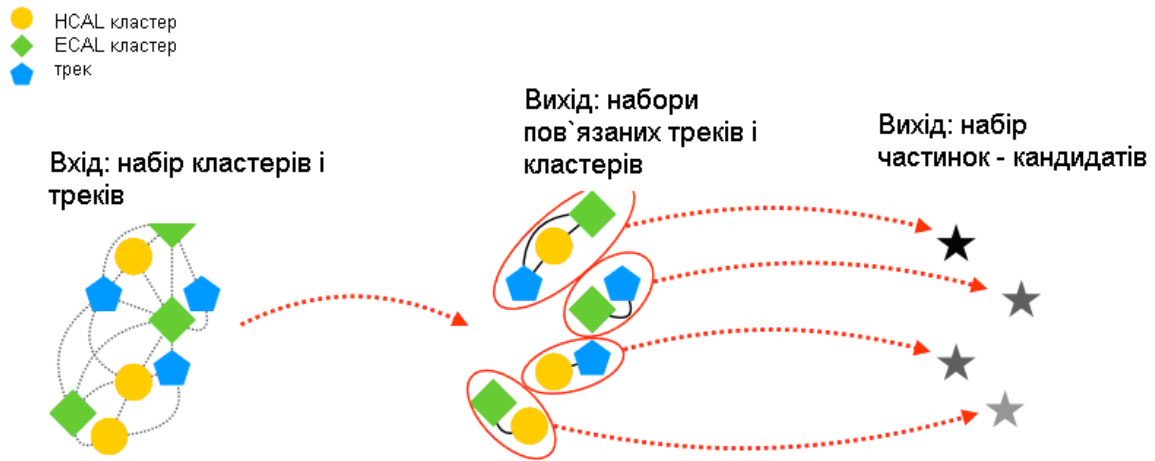
Рис. 2. Схематичне зображення алгоритму виявлення частинок на основі вхідного кластера HCAL, кластерів ECAL та треків.
