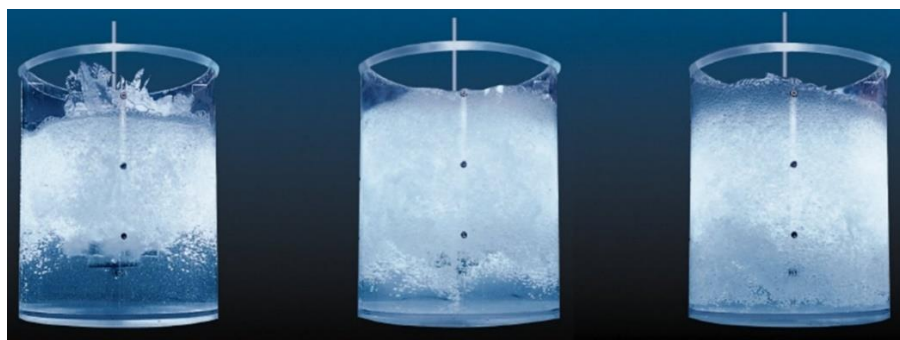
Рисунок 6 – візуалізація роботи мішалок: а – система Раштона; б – система Сміта; в – система Баккера
