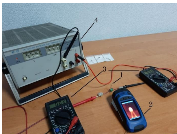
Рис. 1. Макет для проведення випробувань визначення температури терморезистора: а) 1 – терморезистор, 2 – тепловізор, 3 – мультиметри; 4 – джерело живлення
