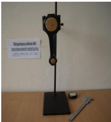
Рис.2. Лабораторна робота «Визначення моменту інерції шатуна».
