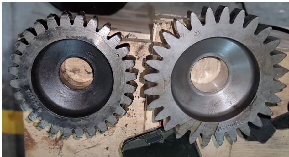
Рис.5. Вигляд зношеного зубчастого колеса (зліва) та нового зубчастого колеса (справа)
