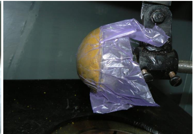
Рис. 4. Капсула з балістичним пластиліном.
