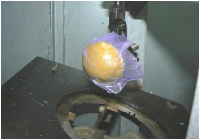
Рис. 3. Кріплення балістичного пластиліну.
