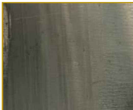
Рис. 8. Фотографічний знімок кобальтового покриття, одержаного із електроліту, що містить: 0,1M Co(ClO 4 ) 2 , 1M NaClO 4 , 0,1M пропанова кислота. pH =1,9
