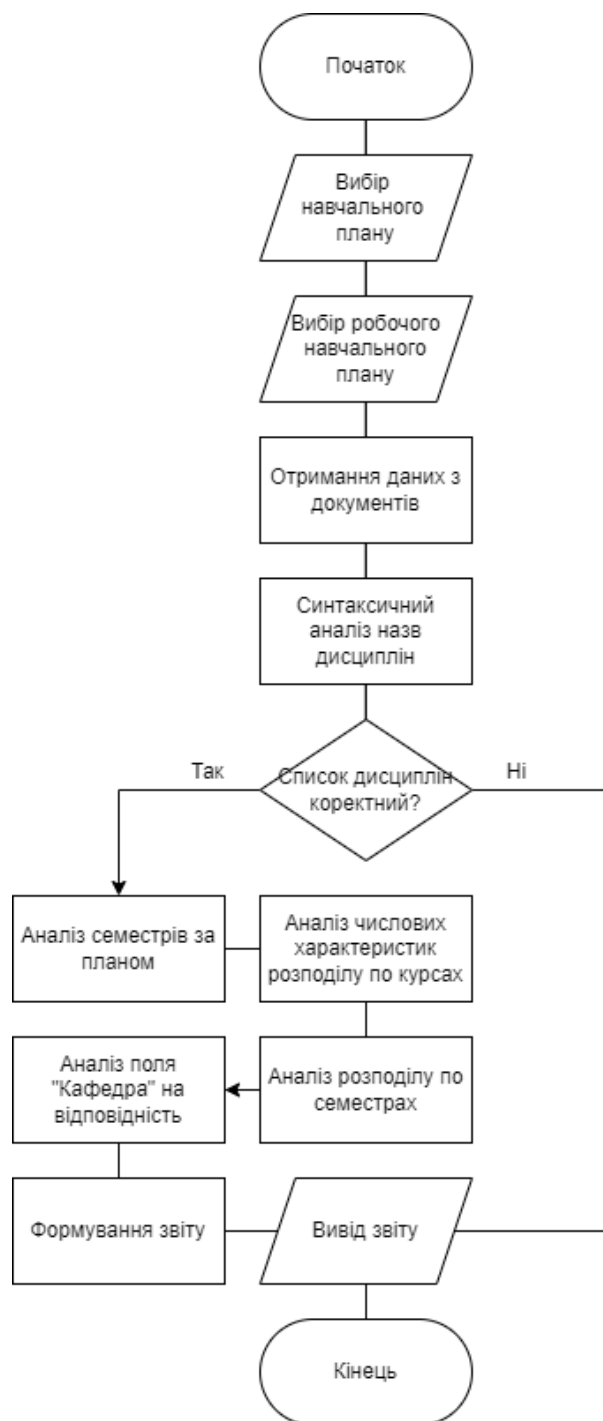
Рисунок 1 – Схема роботи програмного засобу аналізу навчальних та робочих навчальних планів
