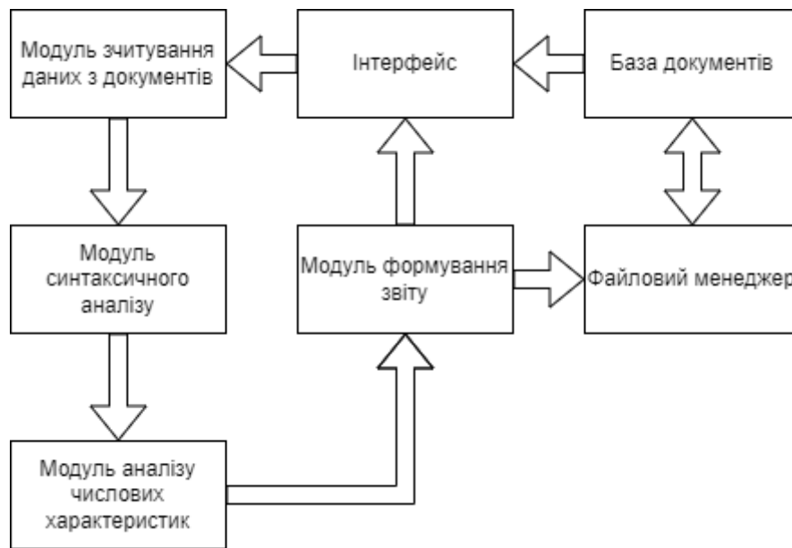
Рисунок 2 – Структурна схема інтелектуального модуля аналізу навчальних та робочих навчальних планів для розрахунку навчального навантаження
