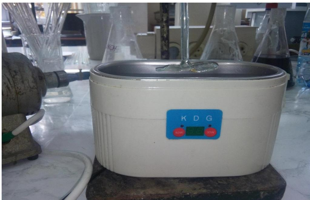
**Рис 2. Експериментальна УЗ-лабораторна установка для екстракції розторопші плямистої**
