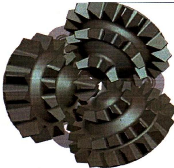
**Fig. 1. Roller-bit 295,3 SB IADC code 217**
