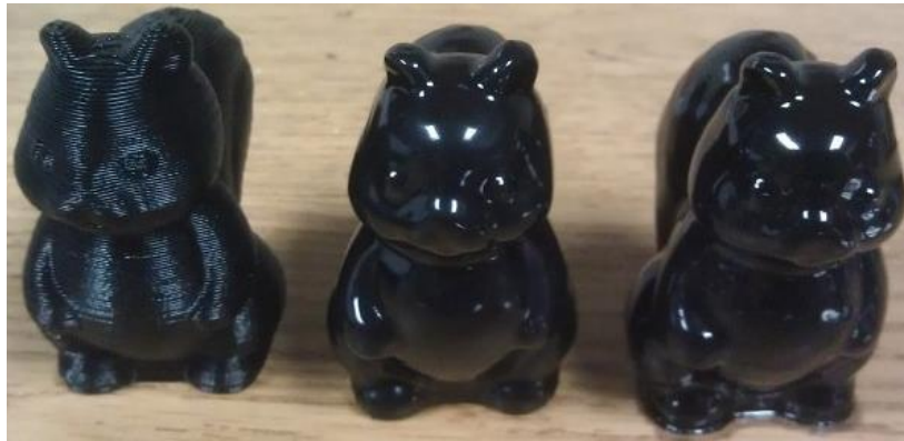
Рис. 3–Оброблені в ацетоні друківані моделі
