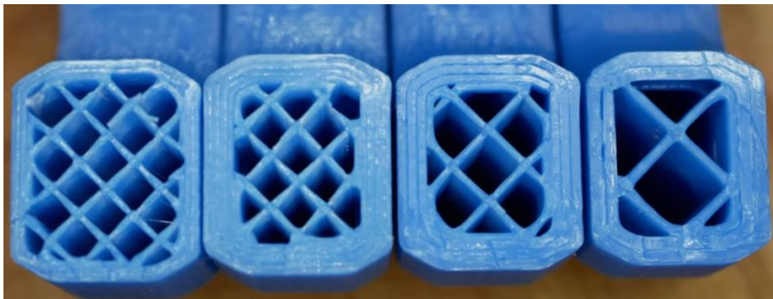
Рис.4–Друківані моделі з різною товщиною стінок
