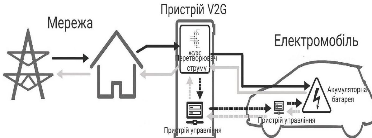
Рисунок 1. Загальний принцип роботи концепції V2G.
