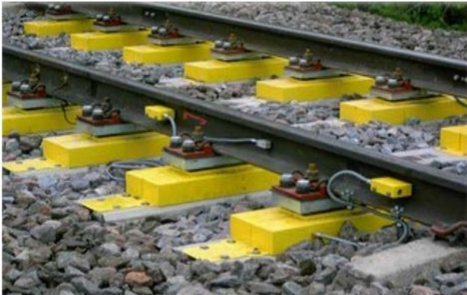
Рис. 4. Діагностичне обладнання системи Multirail WheelScan
