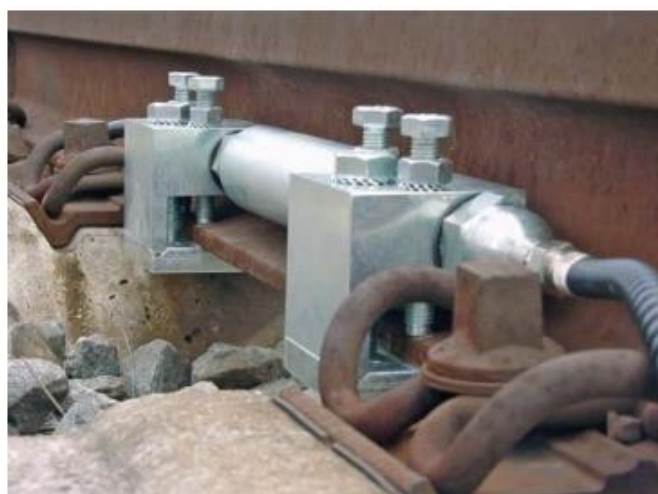
Рис. 1. Лазерний датчик вимірювальної системи Lasca
