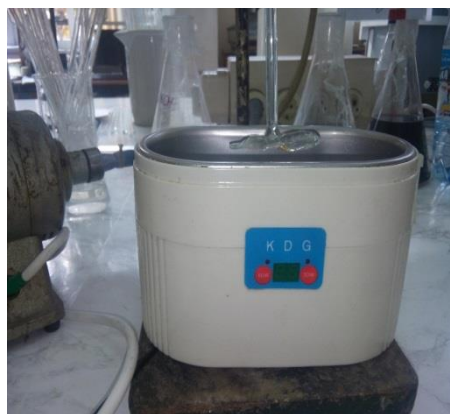
Рис. 1 - Експериментальна УЗ-лабораторна установка для екстракції
