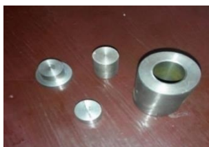
Рис. 2. Зовнішній вигляд штампу та пуансонів. а) штамп для виготовлення формованих таблеток із глини; б) таблетка для проведення хімічного аналізу
