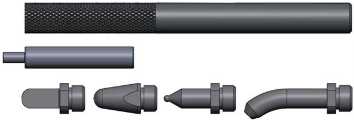
Рис. 1. Зовнішній вигляд пристрою, де показані послідовно: ручка, магніт меншого діаметра, магніт більшого діаметра, плоска насадка, конічна насадка, насадка із кулькою, зігнута насадка.
