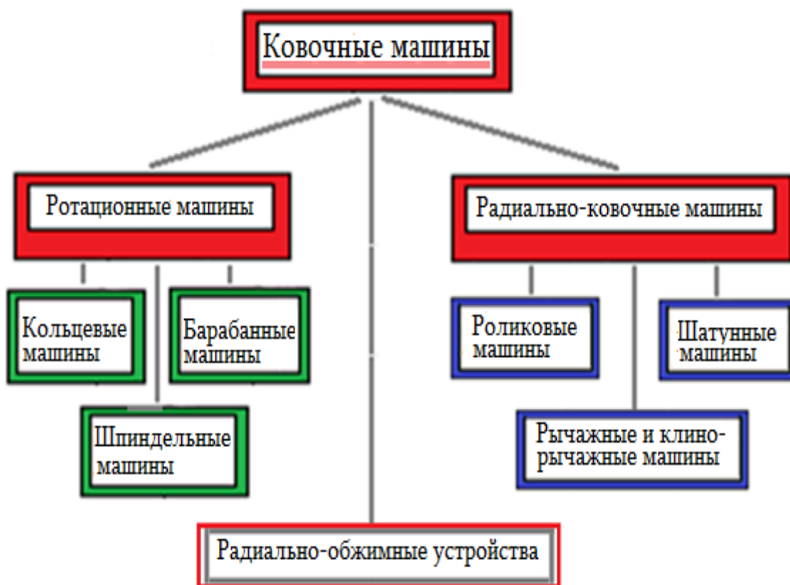
Рис. 1. Классификация ротационно и радиально-ковочных машин
