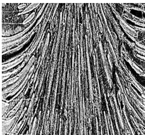
Рис. 5. Вид структури насадки з газара для розпилення палива, діаметр пор 30 – 100мкм
