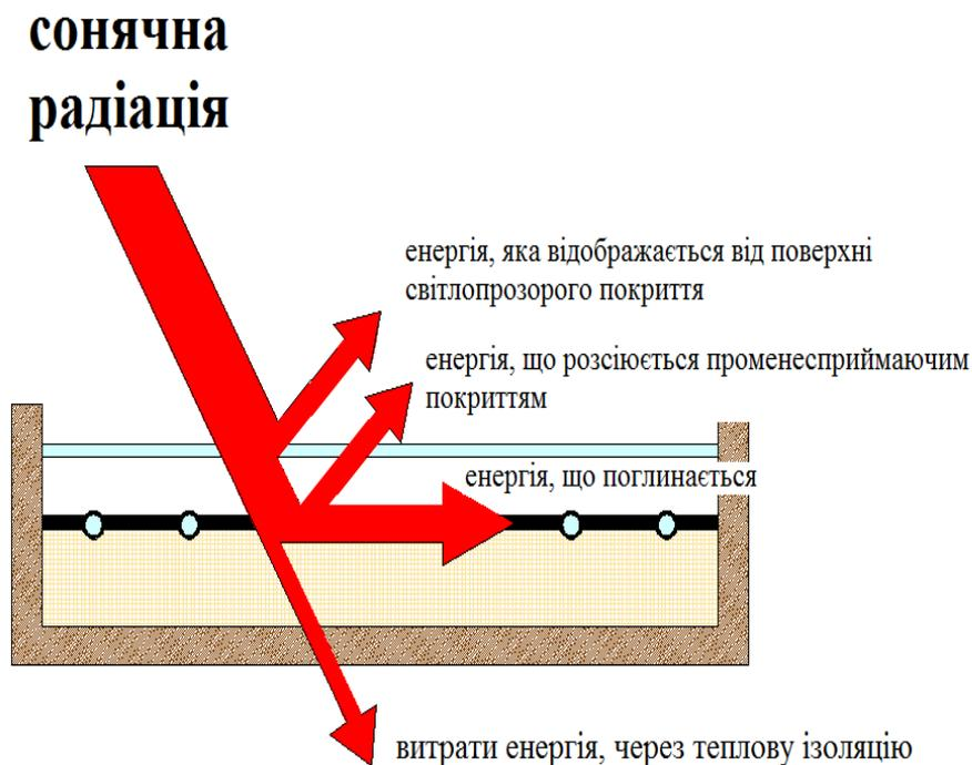
**Рис. 3. Схема теплових потоків в сонячному колекторі**
