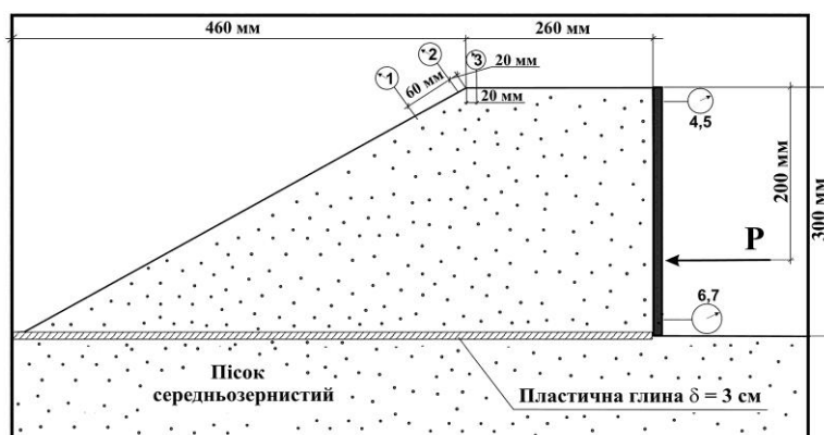
Рис. 3. Схема моделі без ґрунтоармуючої конструкції з прошарком з глини
