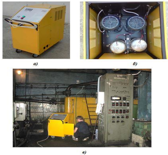
Рис. 2. Мобільна станція для очищення олив: а) – загальний вигляд; б) - моторний відсік; в) – станція в маслоподвалі збагачувальної фабрики
