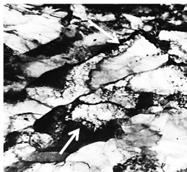
Рис. 4. Субструктура сталі після ГДВ та відпуску при 300 °С протягом 2 год: \times 25000
