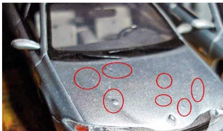
Рис.3. Здуття на поверхні металу при цинковій чумі
