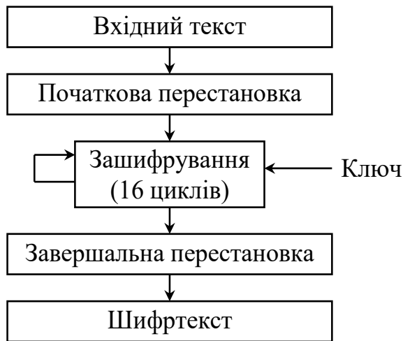
Рис. 2. Узагальнена схема зашифрування в алгоритмі DES
