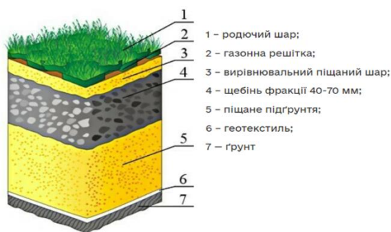
Рис. 2. Пошарова будова екопарковки
