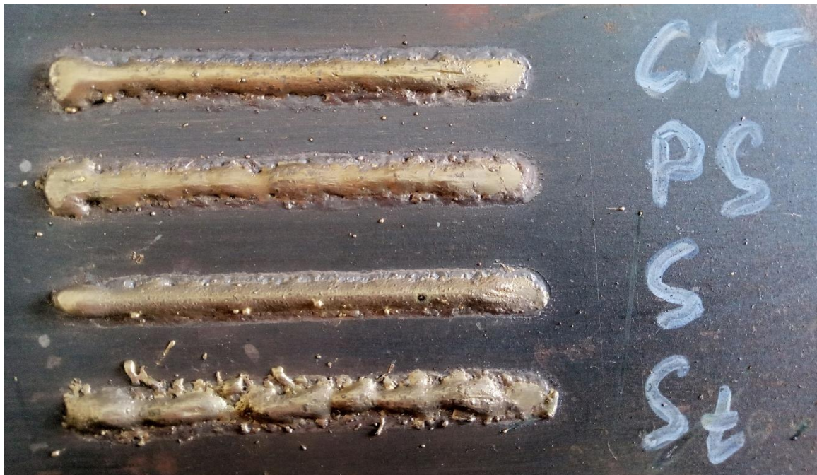
Рис. 3 – Направленні валики методом MIG-пайки в режимах: CMT – Cold Metal Transfer; PS – Pulse Synergic; S – Synergic; St – Standard
