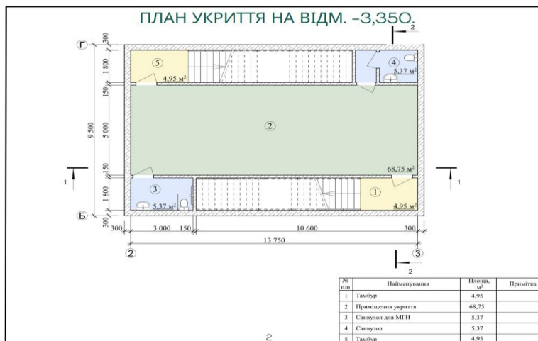
Рис. 2. План укриття на відмітці -3.350
