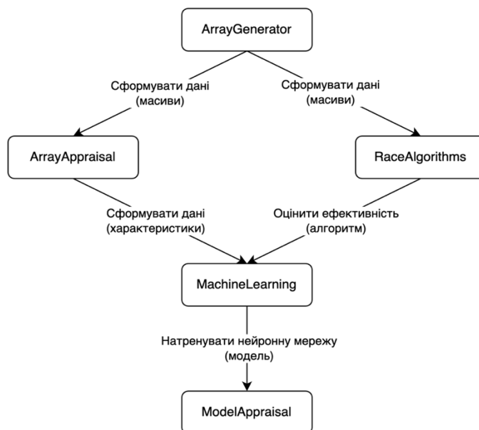
Рис. 1. UML-діаграма взаємодії складових, що реалізують алгоритм навчання моделі
