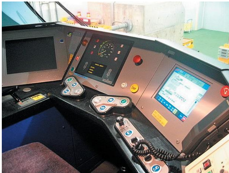
Рис. 5. Кабіна управління поїздом, сумісна з АТО
