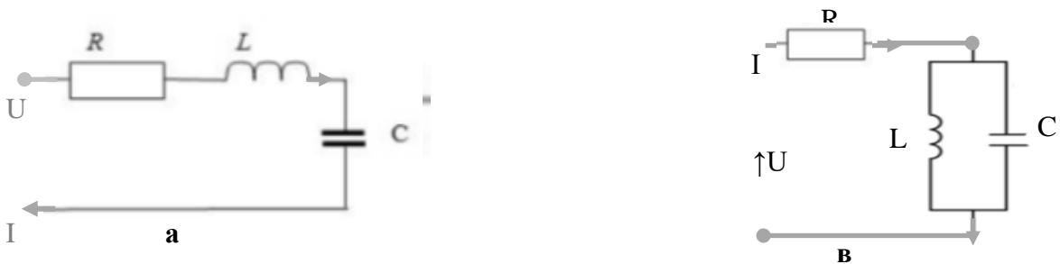
Рис. 2. Пара RLC схем за умов резонансу: а – струму, в – напруги.
