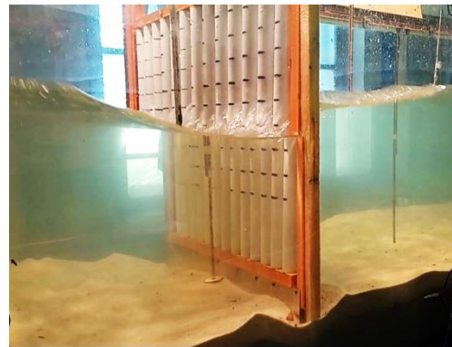
Рис. 2. Момент підходу до моделі проникної вертикальної стінки проникністю 20% гребня гравітаційної хвилі (а) та її підшви (б)
