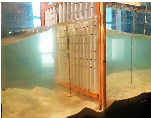
Рис. 2. Момент підходу до моделі проникної вертикальної стінки проникністю 20% гребня гравітаційної хвилі (а) та її підшви (б)
