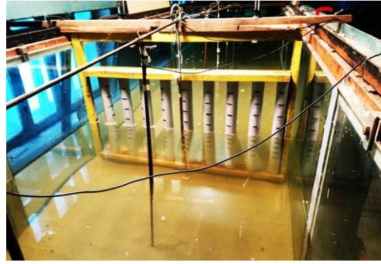
Рис. 1. Моделі проникної вертикальної стінки проникністю 20% (а) та проникністю 50% (б) усередині хвильового каналу
