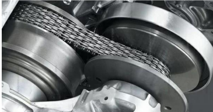
Рис. 2. Схема варіаторної АКПП
