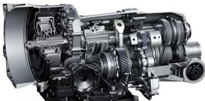
Рис. 3. Схема роботизованої коробки передач
