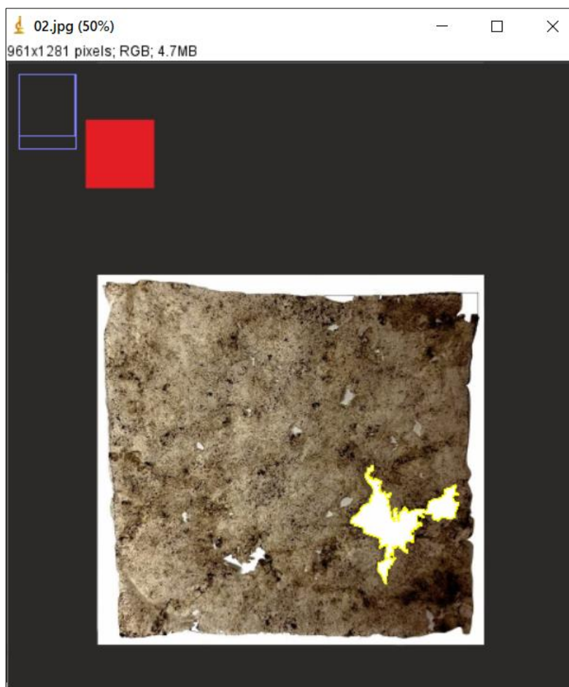
Рис. 1. Робота з фрагментом біорозкладного полімерного пакета (зразок № 2): вимірювання площі ділянки, яка піддалася деструкції у ґрунтовому середовищі за допомогою програми ImagJ (вікно програми без панелі навігації)
