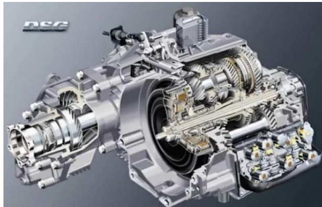
Рис. 4. Схема роботизованої коробки передач DSG 6/7
