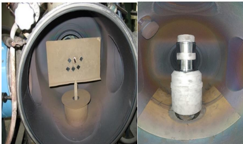
Рис. 5. Розташування на металевому плоскому підкладкотримачі зразків інструментів, що знаходиться у центрі вакуумної камери, [11]
