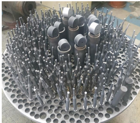
Рис. 2. Фотографія садки з інструментом після проведення процесу азотування [8]
