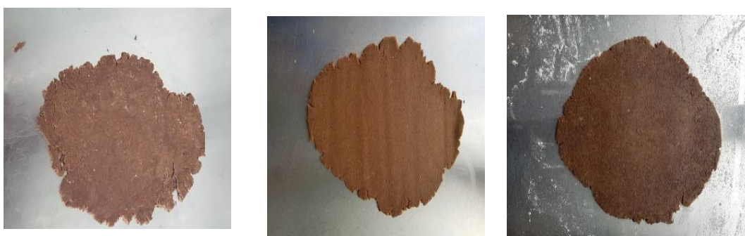
а) зразок без б) зразок з замочуванням в) зразок з замочуванням замочування протягом 10 хвилин протягом 30 хвилин
