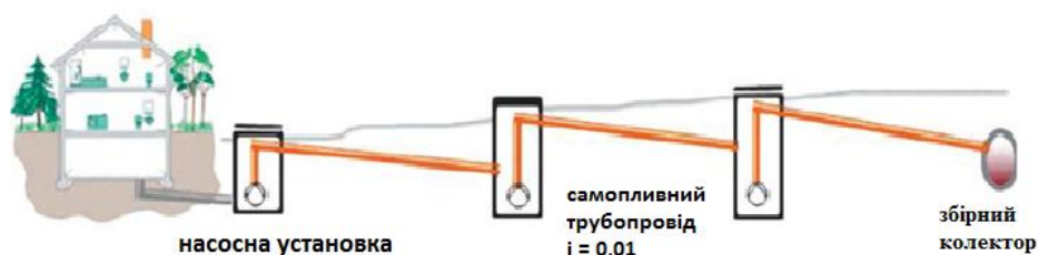
Рис. 1. Самопливна каналізація у поєднанні з механічним підйомом стічних вод
