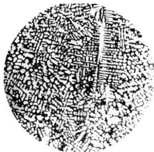
Рис. 1. Структура сплаву 150X5Г9Т5С2, \times 350
