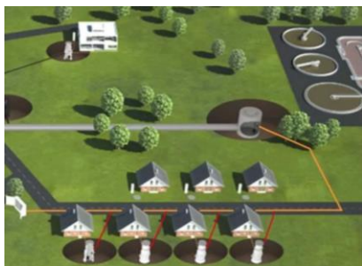
Рис. 2. Приклад системи напірної каналізації у сільській місцевості
