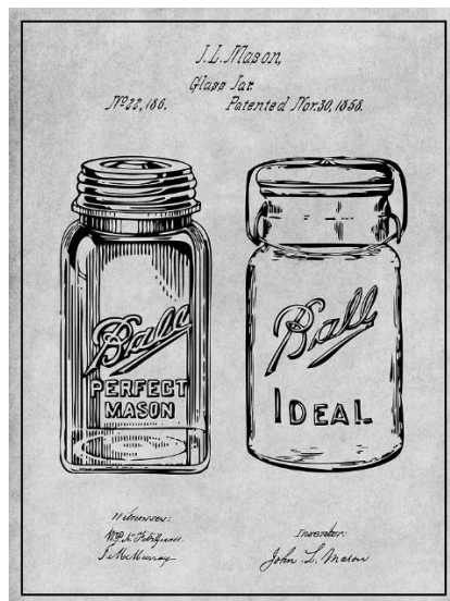
Рис. 6. Патент скляної банки Дж. Мейсона, 1858 р.
