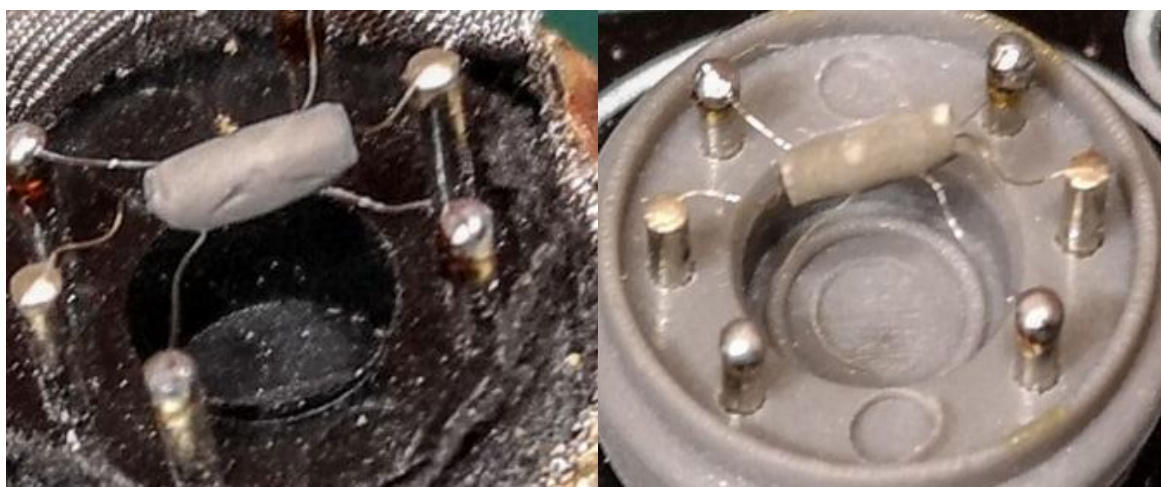
Рис. 3. Внутрішні елементи датчики MQ-2 (ліворуч) і MQ-7 (праворуч)
