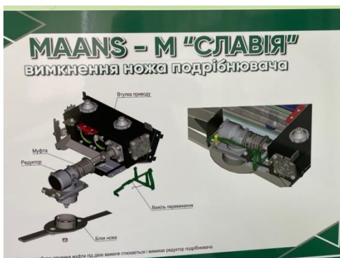
Рис. 1. Модель приводу механізму вимкнення ножа подрібнювача
