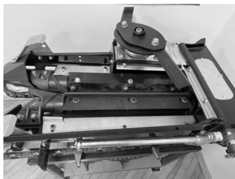
Рис. 2. Механізм вимкнення ножа подрібнювача
